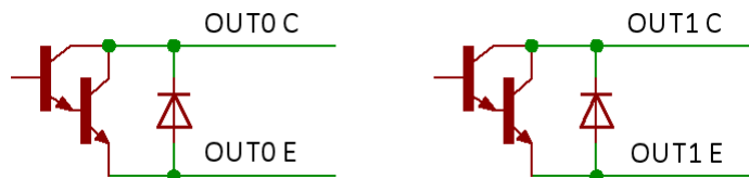
Zapojení alarmových výstupů
